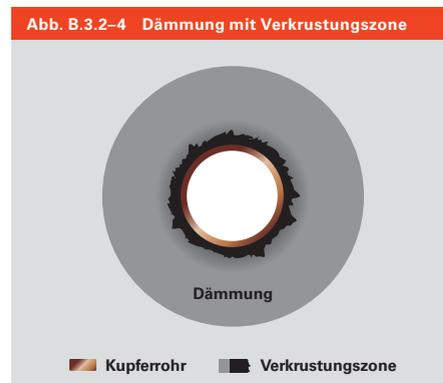
Eine geringe Verkrustung auf der Innenseite geschlossenzelliger Dämmschläuche mit Hochtemperatur-Eignung kann toleriert werden.
