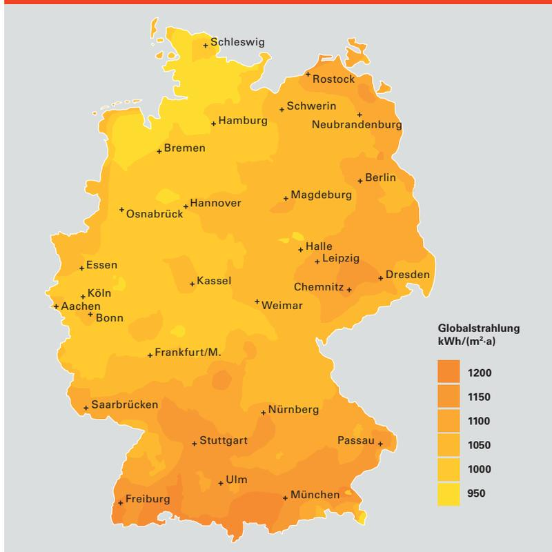
Die durchschnittlichen Jahressummen der Globalstrahlung liegen in Deutschland im langjährigen Mittel zwischen 950 kWh/(m<sup>2</sup>·a) in der norddeutschen Tiefebene und 1 200 kWh/(m<sup>2</sup>·a) im Freiburger Raum bzw. in der Alpenregion. Weltweit liegen die Werte zwischen 800 kWh/(m<sup>2</sup>·a) z. B. in Skandinavien und 2 200 kWh/(m<sup>2</sup>·a) z. B. in der Sahara.
