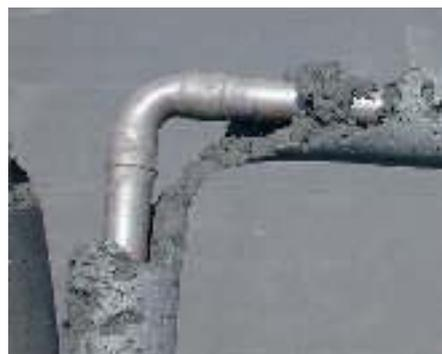
Abb. B.3.2-5 Schaden durch Kleintierverbiss.
