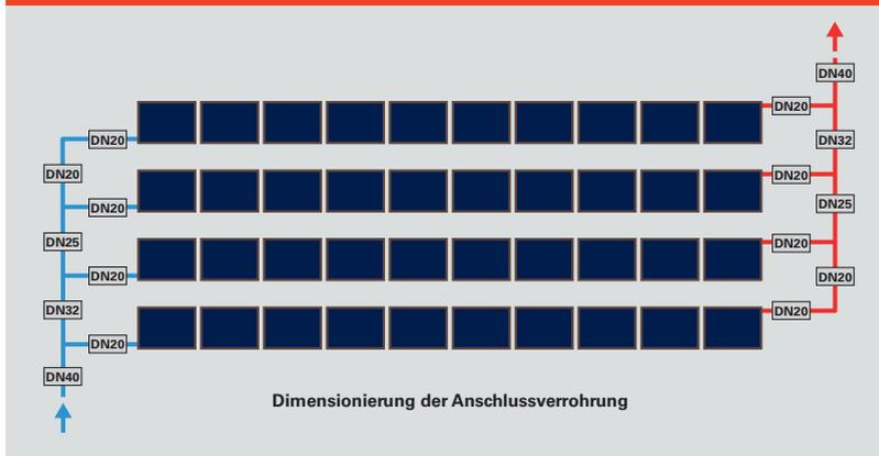
Zur Sicherung der notwendigen Fließgeschwindigkeit müssen die Nennweiten der Anschlussverrohrung auf die spezifischen Volumenströme der Teilfelder ausgelegt sein.
