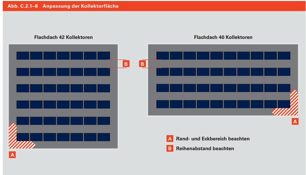
Die rechnerisch optimale Kollektorfläche muss nun den Gegebenheiten auf dem Dach angepasst werden. Nach Möglichkeit sollten immer gleich große Kollektorguppen geplant werden (siehe Kapitel C.1).
