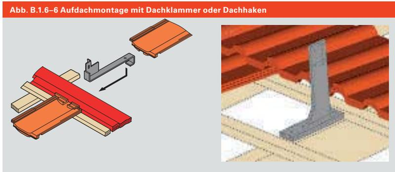
Abb. B.1.6-6 Aufdachmontage mit Dachklammer oder Dachhaken
