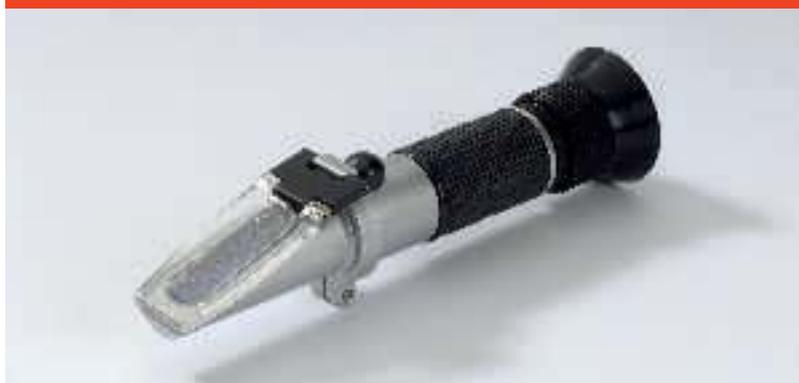
Der Frostschutz kann mit dem Refraktometer über den Brechungsindex genau bestimmt werden.
