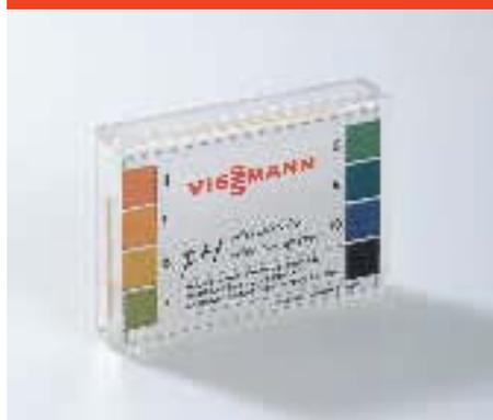
Der Lackmuskstreifen zeigt durch Verfärbung den pH-Wert der getesteten Flüssigkeit.
