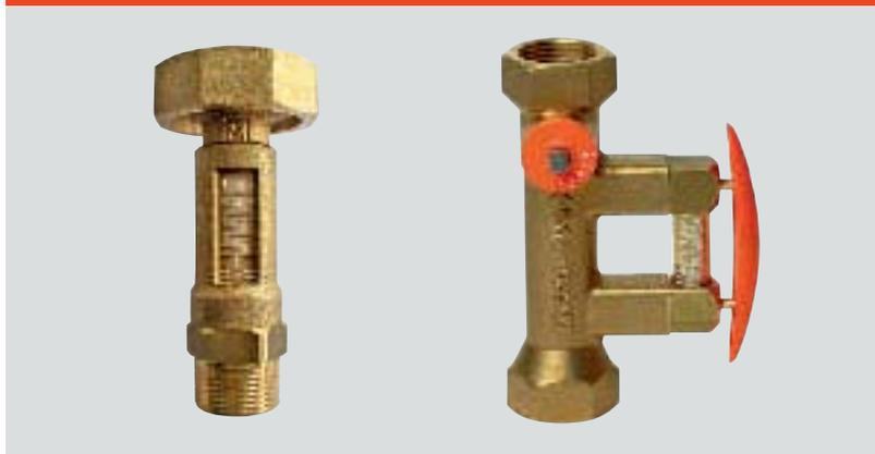
Der Durchflussmengenanzeiger in Inline-Ausführung (links) ist Bestandteil der Solar-Divicon. Zum Abgleich mehrerer Teilfelder wird die Bypass-Ausführung in Kollektornähe eingesetzt.
