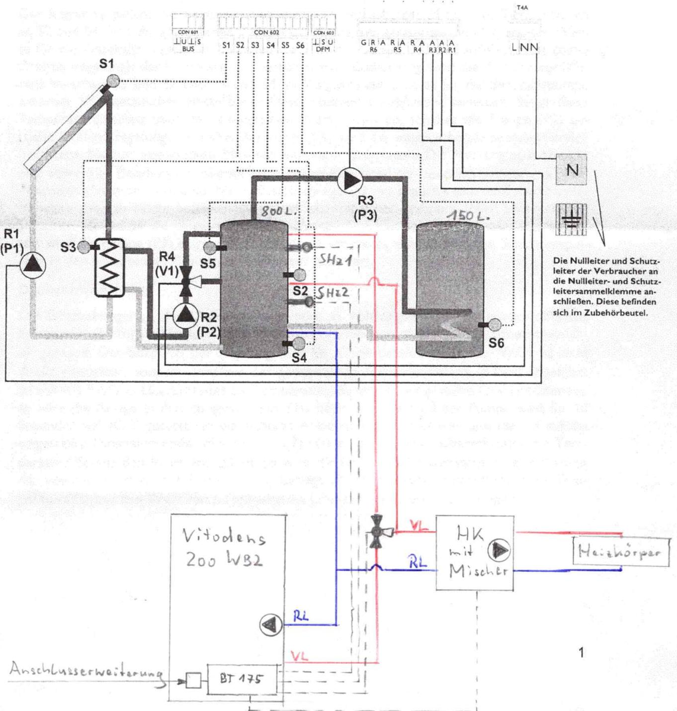
Die Nullleiter und Schutzleiter der Verbraucher an die Nullleiter- und Schutzleitersammelklemme anschließen. Diese befinden sich im Zubehörbeutel.
