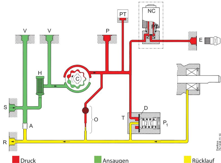
Vom Ansaugstutzen (S) wird Öl durch den Filter (H) zum Zahnradsatz angesaugt, in dem der Druck erhöht wird. Wenn Spannung an das NC-Ventil angelegt wird, öffnet sich dieses und lässt Öl zum Düsenschluss fließen.
