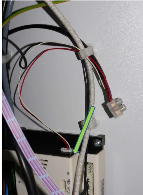
Dieses dann mit dem Schließkontakt des Relais verbinden und die Steuerspule des Relais mit der WLAN-Steckdose verbinden:
