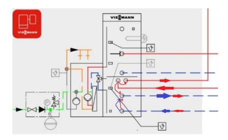
Stufe 3: Die Wärmepumpe ist ab geschalten – es wird keine weitere Energie von der Wärmepumpe über den Sekundärkreis mehr zugeliefert. Die Heizungskreise nehmen jedoch weitere Energie bei Bedarf aus dem System ab. Es läuft nun sozusagen ein innerer Kreislauf ab, indem der Puffer die angeforderte Wärme (als Wärmequelle) an die Heizkreise abgibt.
