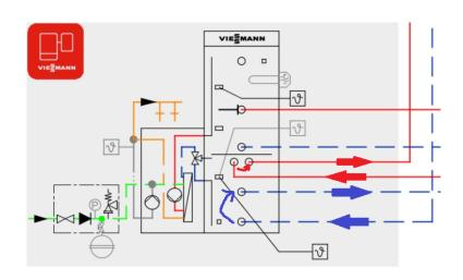
Stufe 2: Sobald die Heizungskreise nicht mehr die gesamte Energie die die Wärmepumpe liefert, von den Heizkreisen abgenommen werden kann, ist der System nicht mehr im Gleichgewicht – Es kann nicht mehr die komplette Heizenergie von der Wärmepumpe in die Heizungskreise geleitet werden, da zb. Mischer von der Regelung entsprechend weit geschlossen werden, oder der Estrich soweit mit Wärme "gesättigt" ist, dass keine weitere Wärme mehr aufgenommen werden kann, u.s.w.
