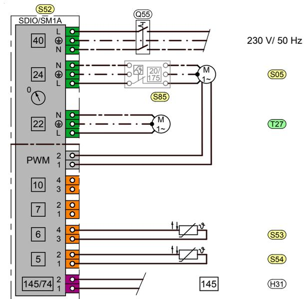
Elektroplan Zubehör: Anschlussbeispiel für ein Umschaltventil mit Dauerphase
