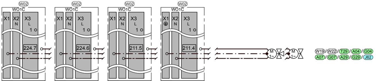
Elektroplan Zubehör: Anschlussbeispiel für ein Umschaltventil mit 2 Spulen, Ansteuerung über Hilfsschütz
