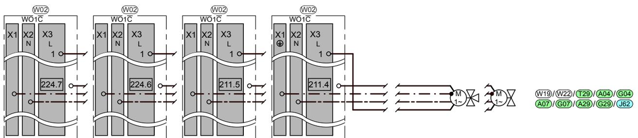
Elektroplan Zubehör: Anschlussbeispiel für ein Umschaltventil mit Federrücklauf
