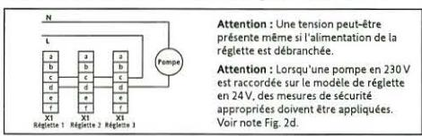
Bild 5a: Connexion d'une pompe de 230 V à une régllette de distribution de 24 V.
