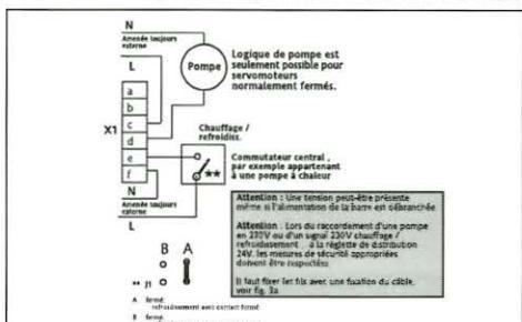
Figure 3a Connexion du signal de la 230V H/C ou d'une pompe 230V à une régllette de distribution 24V
