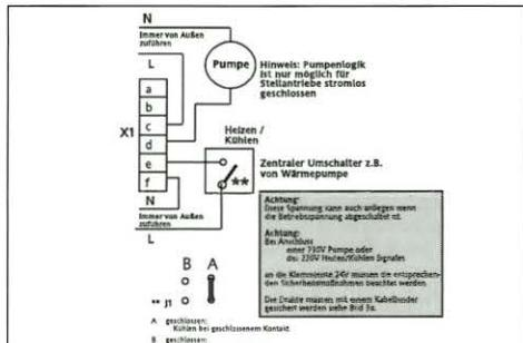
**Bild 3a Anschluss des 230V H/K-Signals oder einer 230V Pumpe an eine 24V Klemmleiste**
