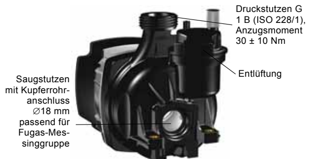
Kunststoffgehäuse CESAO4 mit axialem Saugstutzen und Schnellentlüfter
