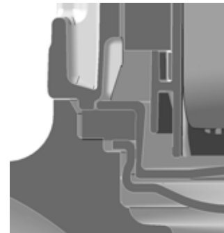
Abb. 48 Schnittzeichnung zur Veranschaulichung des Dichtungsprinzips
