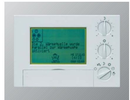
Bild 7: Wärmepumpenregelung CD 60 mit Anlaufstrombegrenzung und integrierter Kühl- und Solarfunktion – bis zu drei Ladegruppen regelbar
