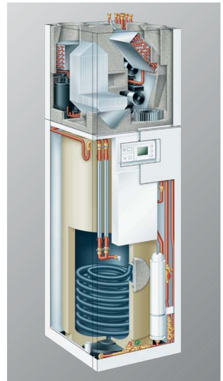
Bild 4: Vitotres 343 – Kompaktgerät für Passivhäuser: Wärmepumpe kombiniert mit mechanischer Wohnungslüftung und Speicher-Wassererwärmer
