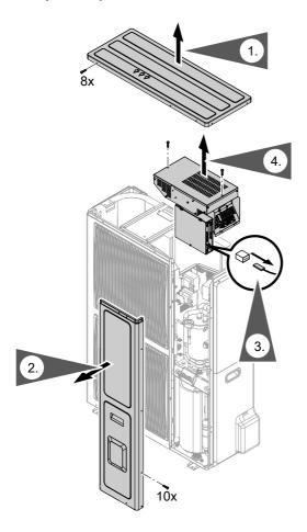
Hinweis zu Arbeitsschritt 3.: Alle Steckverbindungen an der Regelung Außeneinheit trennen.
