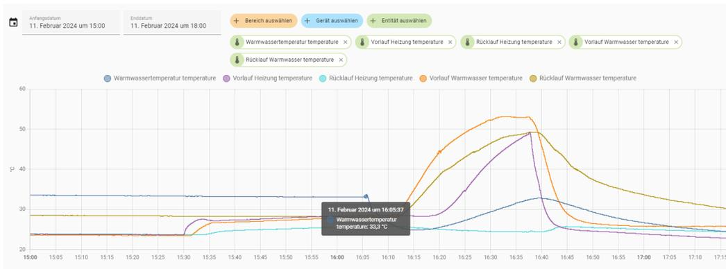
Gegen 15:30 Uhr ist die Heizung angelaufen. Es ist gut zu sehen, wie die Vorlauftemperatur ansteigt, das Heizwasser in den Warmwasserkreislauf gedrückt wird. Die Vorlauftemperatur im Warmwasserkreislauf steigt mit gleicher Temperatur wie die Vorlauftemperatur des Heizkreises. Gut ist auch ersichtlich, wie in der folgenden Warmwasserbereitung das heiße Wasser des Warmwasserkreislaufes in den Sekundärkreislauf der Heizung gedrückt wird und die Temperatur auf knapp 50°C ansteigen lässt.
