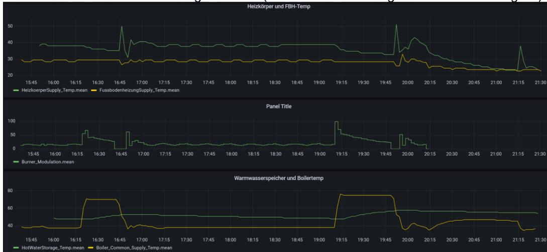
Wird die Modulation mit aufgezeichnet, kann festgestellt werden das vor der Temperaturspitze der Brenner schon auf 0 steht. Somit wird wohl systemseitig einfach abgeschaltet? Das müsste wohl mit Viessmann geprüft werden.
