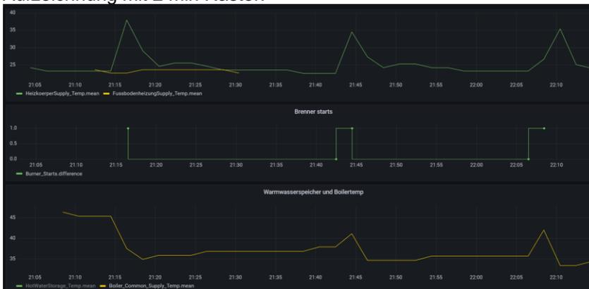
Durch die hohe Häufigkeit der Starts kann vor dem Brenner abgewartet werden, und geprüft werden was hier passiert. Der Brenner springt für ca 1:30 an die Modulation „startet“ bei 61,6 % und fährt dann sehr schnell herunter, um nach der oben genannten Zeit sich auch wieder abzuschalten.
