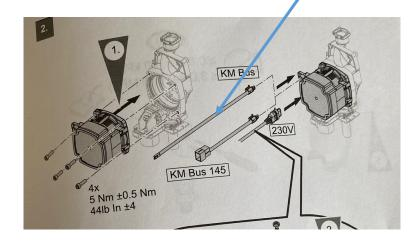
Oder wird das mitgelieferte Kabel an den Steckplatz KM Bus 145 angeschlossen?
