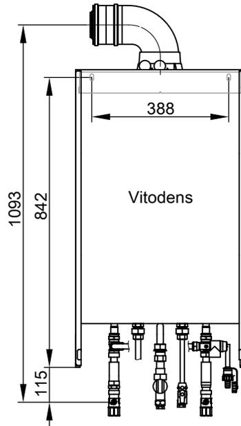
Die vorhandenen hydraulischen Anschlüsse sind maßgleich.
