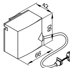
Wird mit einem Spannband befestigt.
