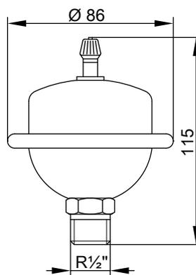
Sind am gleichen Netz wie der Vitodens Entnahmestellen angeschlossen, bei denen Druckstöße möglich sind (z. B. Druckspüler, Wasch- oder Spülmaschinen): Wasserschlagdämpfer in der Nähe des Druckstoß-Verursachers installieren (Empfehlung).
