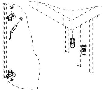
**Anschluss-Set für nebengestellten Speicher-Wassererwärmer Vitocell 100-W und 300-W**
