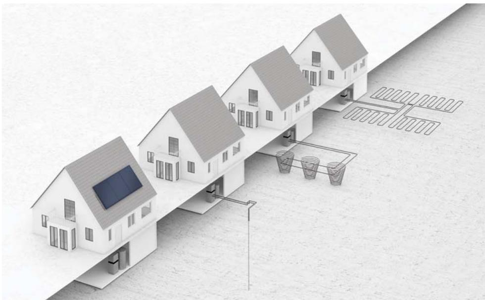
Überall einsetzbar: Vitosorp 200-F kann mit Solarkollektoren oder mit Erdflachkollektoren, Erdwärmekörpern oder Erdwärmesonden betrieben werden.
